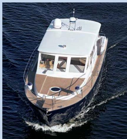
*Форма корпуса V-образная, остроксаулая. Объемный киль с заглубленным в него двигателем позволяет иметь горизонтальный гребной вал. Якорный шпиль – с якорем 25 кг.*
