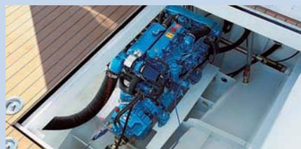
Двигатель французской фирмы «Nanni Diesel» в 115 л.с. выбран не случайно: очень тяговитый, тихий, имеет встроенный промежуточный генератор 220 В и при этом заметно дешевле аналогов, хотя компания поставляет морские двигатели таким гигантам, как «Beneteau», «Jeanneau» и «Dufour». Места в моторном отсеке хватит еще на два генератора.
