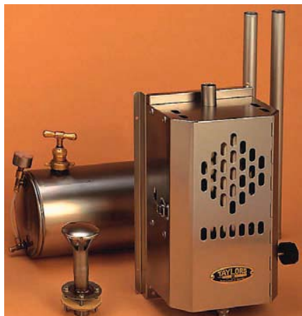
Штатный комплект поставки керосиновой печки «Taylors 079K/HTK0531» из нержавеющей стали. Габариты корпуса: 242 × 165 × 407 мм, масса – 11 кг. Дымоход: диаметр – 28 мм, длина – 1 м (две секции по 50 см). Высота дефлектора над палубой – 124 мм.
