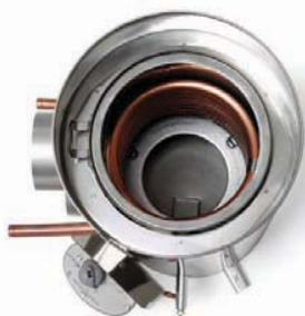
Напольная дизельная печь «Glembing IG 92/6» с встроенным змеевиком (вид сверху). Если вы решились заказать печь со змеевиком для подключения к радиаторам в смежных каютах, нужно их подключить, не откладывая дело на потом. Иначе змеевик будет поврежден при работе печи из-за отсутствия в нем воды.
