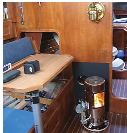
Напольная дизельная печка «Glembring IG 92/6» (0.5–2 кВт) с большим смотровым окошком. Дымоход проложен через переборку в смежную каюту. В результате – более аккуратный монтаж и частичное отопление смежной каюты.
