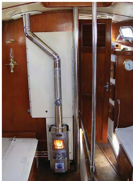
Дизельная печка «Newport» фирмы «Dickinson Marine» с барометрической заслонкой на дымоходе. В этой установке предусмотрена также функция подогрева горячей воды для бытовых нужд.
