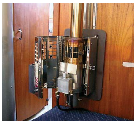
Печка «Sig-100» с открытой дверцей. На нижней части корпуса расположен расходомерный клапан.
