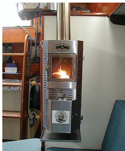
Внешний вид дизельной/керосиновой печки «Newport», установленной на переборке в кормовой части над диваном
