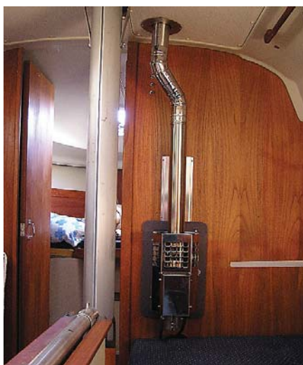
Теплопроизводительность, мин./макс. – 5500/13000 БТЕ/ч (1.6/3.8 кВт); расход топлива, соответственно, 3.6/8.7 л/сутки. Встроенный вентилятор тяги (12 В). Диаметр дымохода – 76 мм. Габариты: 222×248×445 мм. Масса – 5.5 кг. Изготовитель – фирма «Sig Marine Ltd.», Канада.
