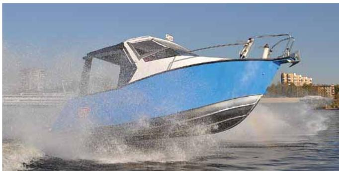
«King Fisher 560»: длина – 5,63 м, ширина – 2,2 м; масса – 650 кг; килеватость – 16 град.; высота транца – 510 мм; высота борта на миделе – 0,85 м; пассажировместимость – 6 чел.; грузоподъемность – 800 кг; рекомендуемая мощность мотора – 90–125 л.с.
