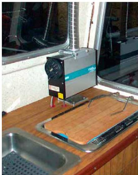
**Самостоятельно выполненный открытый монтаж керосинового отопителя «Wallas 1300» на катере «С-Dory 22» с прокладкой коаксиального дымоотвода через крышу рубки.** Отопитель закреплен на столешнице секции мойки и камбузной плиты (накрыта разделочной доской). Наверное, это не самый удачный вариант.
