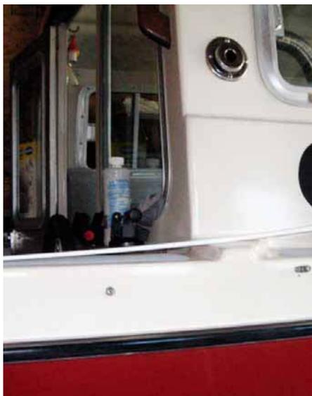
**Аналогичный монтаж «Wallas 1300» на другом таком же катере,** но здесь коаксиальный дымоход проложен через стенку рубки. Дымоотвод выгнут коленом для предотвращения проникновения брызг забортной воды в отопитель. Снаружи виден дымовой фитинг (кстати, он не слишком горячий во время работы отопителя).
