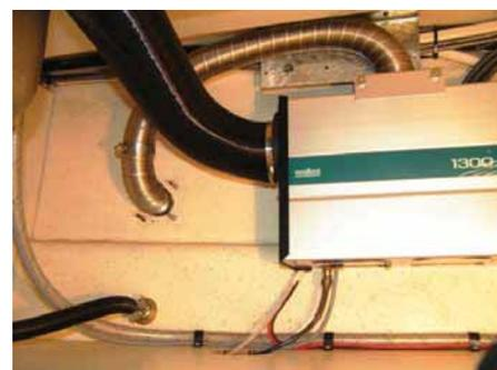
**На этом снимке виден черный шланг подачи горячего воздуха в салон (диаметром 75 мм) и выгнутый коленом коаксиальный дымоотвод (диаметром 28/45 мм), под которым расположен черный сливной фитинг от мойки. Обратите внимание на самодельный оцинкованный уголок, закрепленный на расстоянии 6 мм от стеклопластикового корпуса лодки. Этот уголок не позволяет коаксиальному дымоотводу (хотя снаружи он не очень горячий) касаться стеклопластика.**
