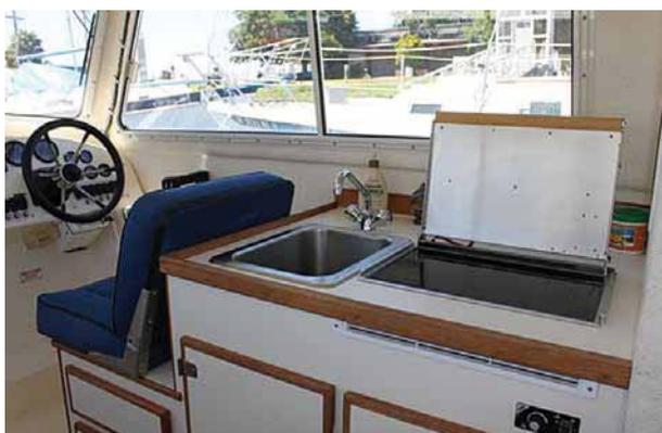
**Комбоплита «Wallas 85DU/270»**, установленная на моторном катамаране «С-Dory 255 TomCat». Под столешницей видна решетка забора воздуха на горение. Дымоход проходит под столешницей, снаружи виден только небольшой дымовой фитинг.
