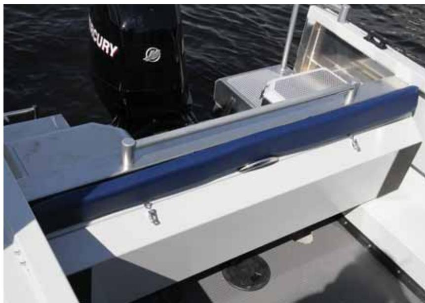
достойная березовая фанера покрыта слоем рифленого полипропилена толщиной 1.5 мм. Из схожего ламината, только с более тонким «рисунком», выполнен и откидной столик по левому борту.
