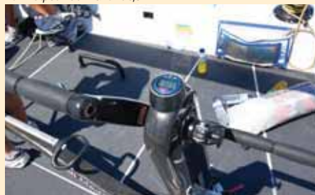
Часы предстартового отсчета теперь монтируют на «кофейной мельнице»
