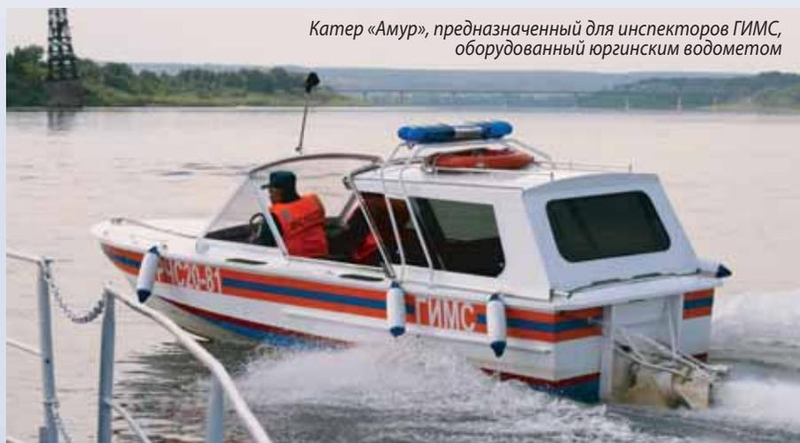
Катер «Амур», предназначенный для инспекторов ГИМС, оборудованный юргинским водометом
