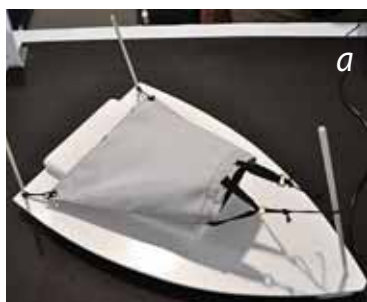
Новый подход к затенению люков: солнцезащитный навес «Hatch Hoodie» американской фирмы «Vapeer Bay»: а – в сложенном виде, б – в рабочем положении. «Hatch Hoodie» также защищает открытый люк от дождя, а еще выполняет роль вентиляционного ветрозаборника-виндскупа.
