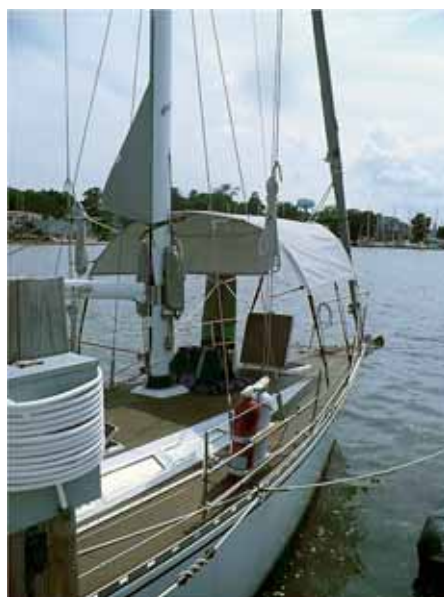
Солнцезащитный каркасный навес над открытым форлюком. Когда яхта направлена носом к ветру, через открытый люк поступает достаточно много свежего воздуха. Тент не дает раскаляться воздуху, поступающему через люк, а также позволяет держать его открытым во время дождя.
