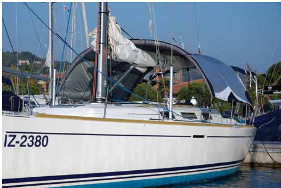
Тент-палатка торговой марки «Gaastra» (продается также под маркой «Ronstans») с надувными арочными стойками над рубкой и бимини над кокпитом
