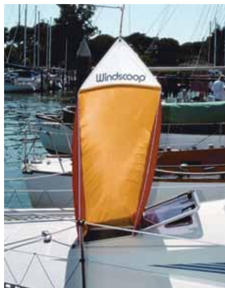
На стоянке в марине: виндскуп «Davis 291», повернутый к бризу, дующему со стороны левого борта. На снимке видно, что при этом он также затеняет люковый проем.
