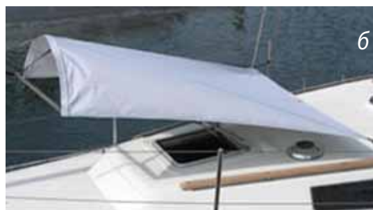
Новый подход к затенению люков: солнцезащитный навес «Hatch Hoodie» американской фирмы «Vapeer Bay»: а – в сложенном виде, б – в рабочем положении. «Hatch Hoodie» также защищает открытый люк от дождя, а еще выполняет роль вентиляционного ветрозаборника-виндскупа.
