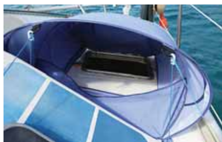
Противодождевой виндскуп «Dorcap Light», установленный в режим максимальной вентиляции: два небольших пластиковых крючка зацеплены за два кольца на верхней тканевой полке капюшона, удерживают полку в натянутом положении с помощью натяжных линий. Для установки виндскупа с целью защиты от дождя пластиковые крючки с линиями нужно отсоединить, продеть через кольца и потянуть вниз, чтобы зацепить крючки за нижние кольца, к которым прикреплены натяжные линии.
