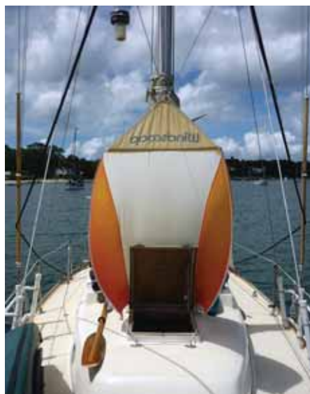
На якоре лодка разворачивается носом к ветру, и в этих условиях односторонний виндскуп работает достаточно эффективно. На фото: виндскуп «Davis 291» американской фирмы «Davis Instruments Corp». При такой его установке люк можно закрыть в случае дождя, не убирая виндскуп.
