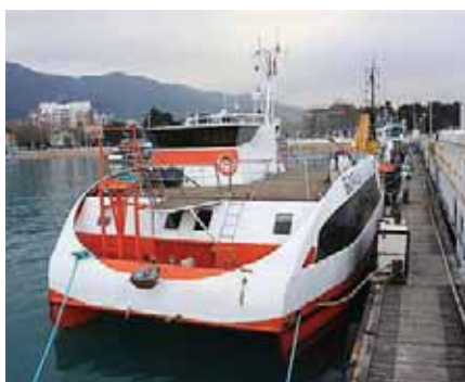
« Борей », экспедиционный катамаран, длина – 19,5 м, ширина – 8,75 м, масса – 60 т, двигатели – 2×400 л.с.
