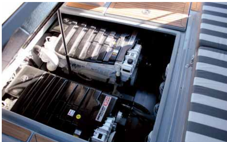
Двухмоторная установка плотно «упакована» под самоподъемной крышкой отсека
