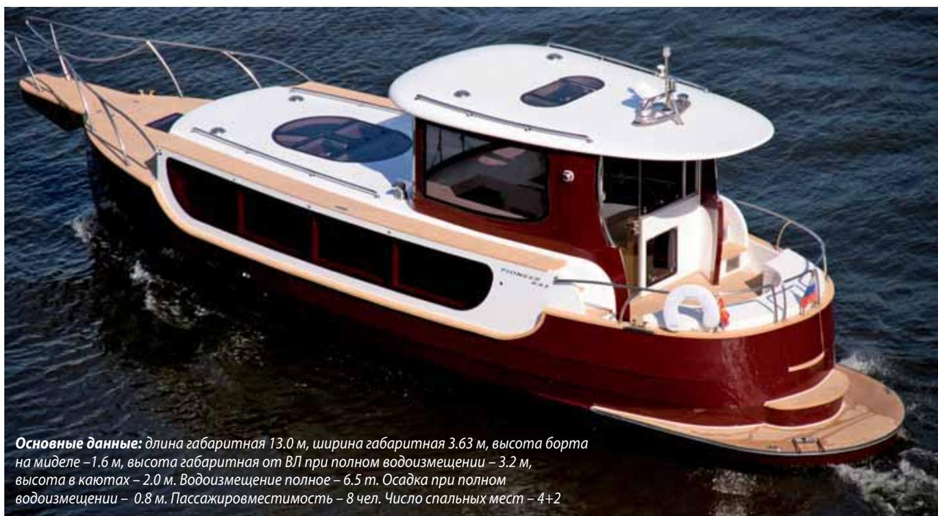
**Основные данные:** длина габаритная 13.0 м, ширина габаритная 3.63 м, высота борта на миделе – 1.6 м, высота габаритная от ВЛ при полном водоизмещении – 3.2 м, высота в каютах – 2.0 м. Водоизмещение полное – 6.5 т. Осадка при полном водоизмещении – 0.8 м. Пассажировместимость – 8 чел. Число спальных мест – 4+2
