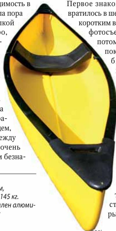
**Основные данные каноэ «Остров»:** длина – 3450 мм, ширина – 850 мм, высота – 300 мм (мин.), 435 мм (макс.). Вес – 25 кг. Грузоподъемность – 145 кг. Материал – монолитный полиэтилен толщиной 3–4 мм, борт обрамлен алюминиевым профилем, что придает дополнительную жесткость корпусу
