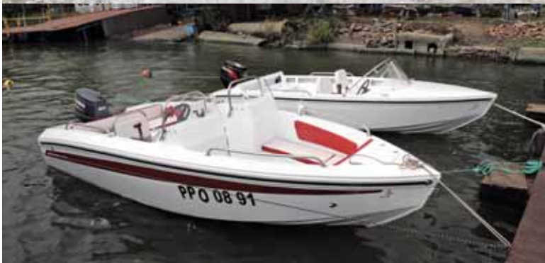
Два варианта компоновки «Дончак» в одном корпусе
