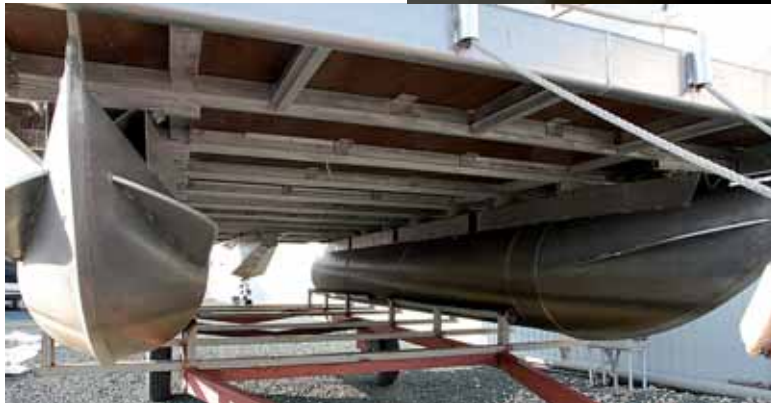
Круглые поплавки у Oasis соединены мостом с частым алюминиевым набором
