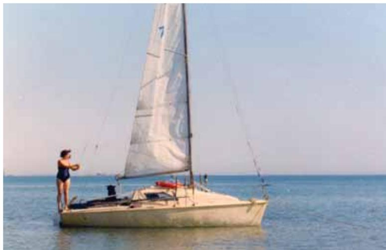
трубу ( $\varnothing=70$  мм) от радиомачты и кувалдой насадил по эпоксидке на мачту «вторым слоем» и приклепал, сделал топовое вооружение. Два ахтерштага, по 2 нижние ванты. Крепление вант перенес с рубки на борт. Краспицы удлинил и забил в них планки из лиственницы на эпоксидке. Восьмибалльный шторм эта конструкция выдержала, несмотря на дикие хлопки стакселя при подъеме на гребень волны из затишка во впадине.
