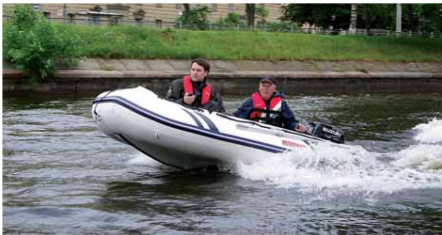
Испытания проводились на речном течении (5 км/ч) на надувных лодках Suzumar 320 (50 кг) и Suzumar 360 (70 кг). На обоих движках стояли винты 9½ × 10. Вес одного человека – 90 кг. В скобках скорость лодки против течения
