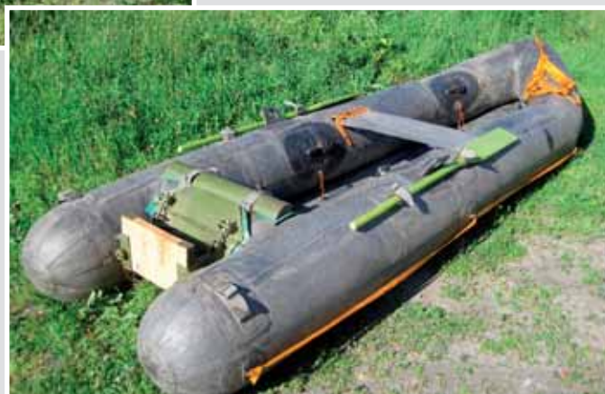
Основные данные лодки: длина – 4.2 м, ширина – 1.36 м, вес – 55 кг, диаметр баллона – 0.45 м.
