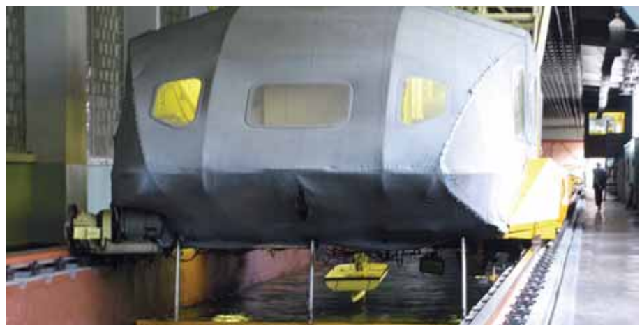
Рис.1. Модель ВГС, подвешенная под буксировочной тележкой, направляется на стартовую позицию для демонстрационного прогона
