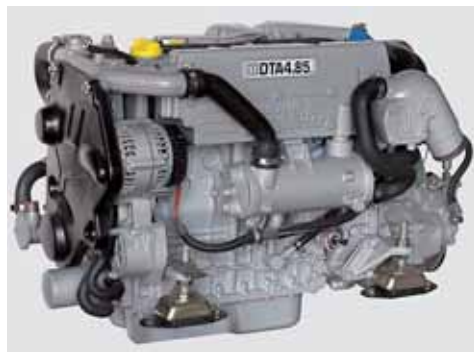
Рис. 2. Дизель VETUS DT4.85 (на базе промышленного дизеля DEUTZ). Мощность – 85 л.с., 4 цилиндра, число оборотов – 3000 об/мин, объем цилиндров – 2290 см 3 , вес с редуктором – 298 кг
