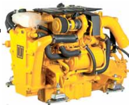
Рис. 3. Дизель Vetus VF 190E. Используется система Common Rail, турбонаддув с изменяемой геометрией. Мощность – 190 л.с., 4 цилиндра, число оборотов – 4000 об/мин, объем цилиндров – 1910 см 3 , вес с редуктором – 276 кг, масса редуктора – 35 кг
