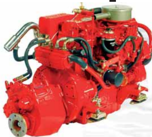
Рис. 1. Дизель Beta 90 (на базе дизеля Kubota). Форкамерный дизель мощностью 90 л.с., 4 цилиндра, число оборотов – 2600 об/мин, объем цилиндров – 3769 см 3 , вес с редуктором – 425 кг, масса редуктора – 35 кг
