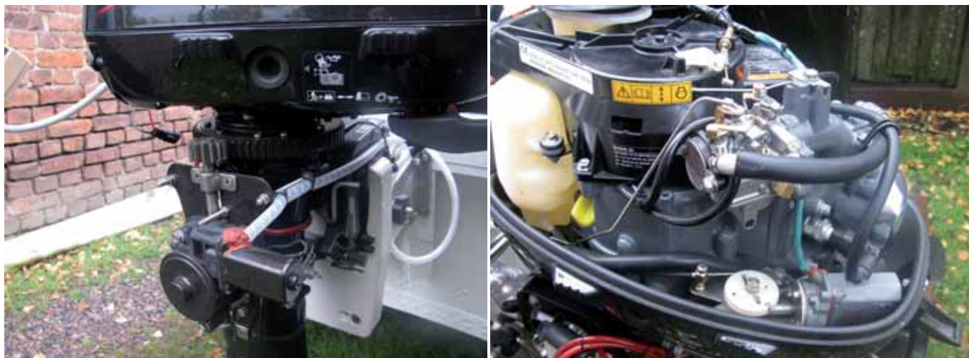
Доработке подвергся даже вспомогательный мотор. Управление с помощью электропривода и по курсу, и по «газу»
