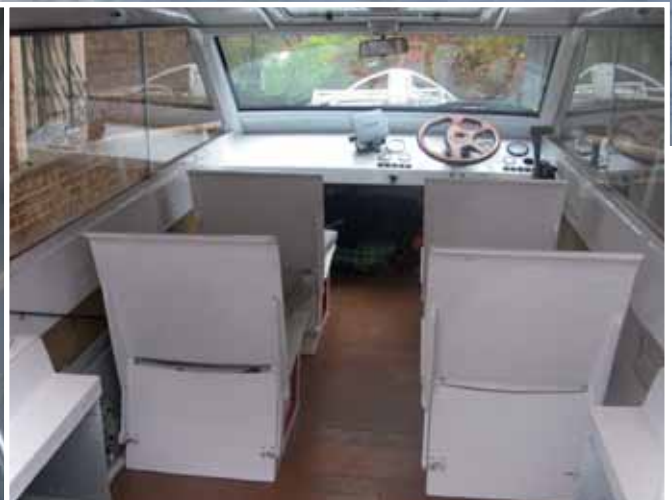
Четыре сиденья в кокпите имеют оригинальную конструкцию, при необходимости раскладываются в сплошную лежанку
