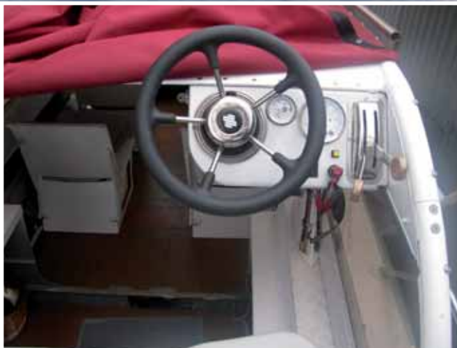
Второй пост управления радикально расширил возможности рулевого и сделал «Амур» настоящим «круизером»
