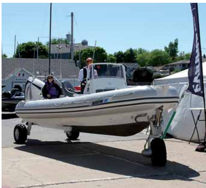
Evinrude G2 и амфибийный РИБ SeaLegs как будто созданы друг для друга – оба используют интегрированные в конструкцию вспомогательные агрегаты
