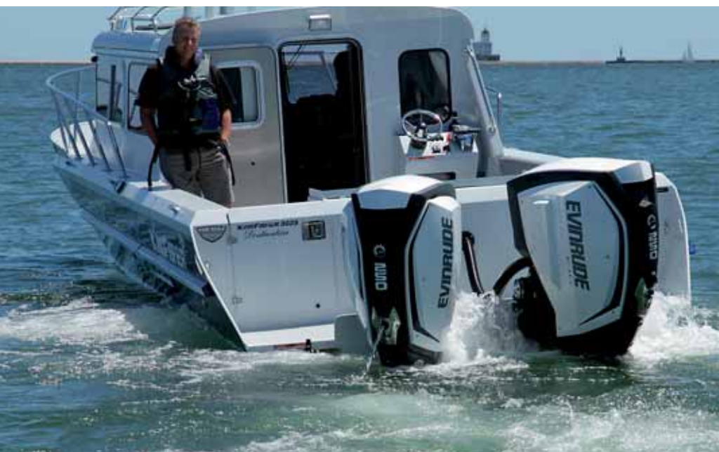
Система управления сдвоенной установкой с помощью джойстика I-Dock сильно облегчает швартовку в стесненных условиях
