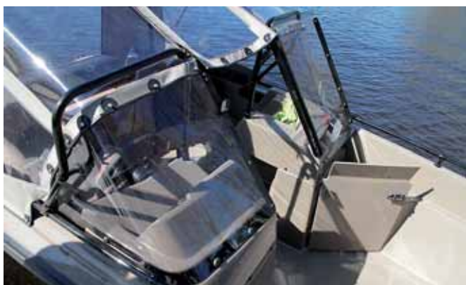
Компоновочные решения «490-й» типичны и хорошо отработаны: две консоли, «калитка» в проходе, тент. Есть место и приятным нюансам вроде затемненных краев стекол или «сплюсненной» снизу баранки руля
