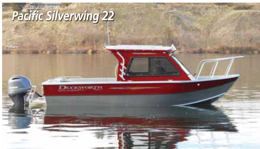
Длина – 7.30 м, ширина – 2.60 м, масса корпуса 1417 кг, макс. мощность – 300 л.с.
