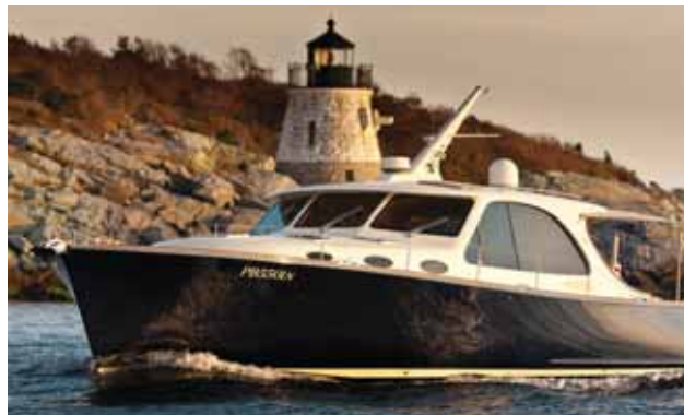
Palm Beach PB 55: длина – 18.3 м, ширина – 5.24 м, осадка – 1.06 м, водоизмещение порожнем – 18 т, двигатели – 2×800 л.с. IPS, запас топлива – 2 600 л, запас воды – 1200 л
