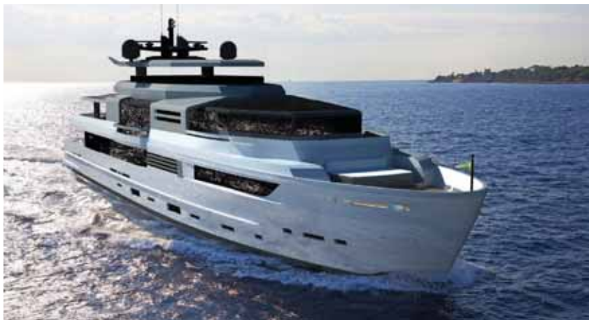
Arcadia 100: длина наибольшая – 29,2 м, ширина – 7,75 м, осадка – 1,90 м, водоизмещение – 110 т, двигатели – 2×1000 л.с., запас топлива – 16 000 л, запас воды – 3200 л
