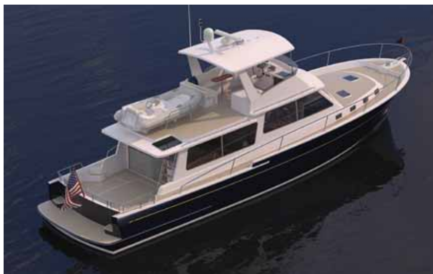
Duffield 58: длина – 18 м, ширина – 4.88 м, осадка – 0.91/1.75 м, водоизмещение – 21.8 т, двигатель – 609 л.с., запас топлива – 2 544 л, запас воды – 568 л
