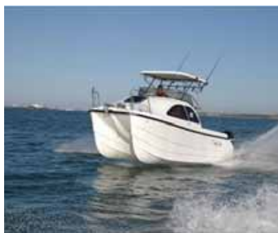
Рис. 3. Ударные нагрузки на днище катамаранов. Справа – катамаран проекта AT620 Cabin на ходу; очевидно, что при прыжках на волне ударам подвергается все днище. Выше – распределение нагрузок на днище по длине катамарана по правилам разных КО. Обратим внимание, что по стандарту ISO с ростом расчетных ускорений давление на днище принимается распределенным равномерно – это как раз случай возможного прыжка на волнении. Также заметим, что требования Российского морского регистра (PC BCC) находятся «в противофазе» ко всем остальным, что неудивительно, поскольку, по словам разработчиков раздела, эти методы были изначально предназначены для водоизещающих катамаранов
