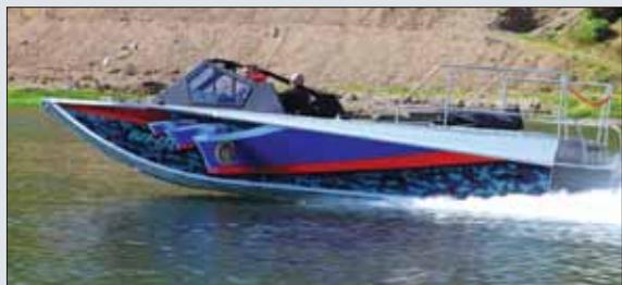
**Сургут.** В начале июня сургутский клуб экстремального туризма «Андреевский» провел тесты оригинального алюминиевого катера собственной разработки – «Сургутская аппарель 745» с двигателем Suzuki 200. Катер предназначен для буксировки, перевозки грузов (до 2 т) или мотовездеходной техники (на борт может взять два квадроцикла). Дизайн и геометрия корпуса родились из конкретных требований суровых условий навигации на многих реках Западной Сибири.
