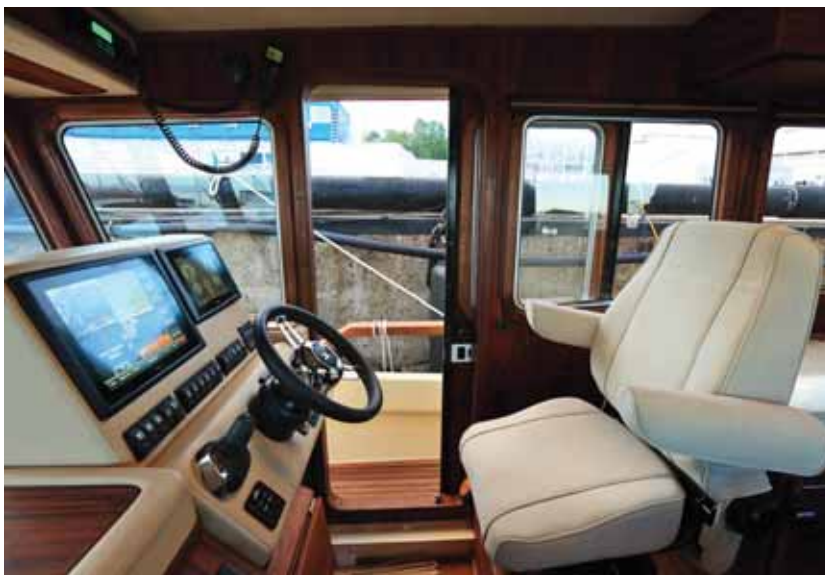
Панель управления по-современному лаконична: основные приборы контроля и навигации заменяют сенсорные экраны
