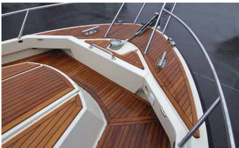
Умеренная глубина палубного прохода дала возможность увеличить объем обитаемых помещений в корпусе
