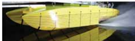
Рис. 1. Модель катамарана при испытаниях на тихой воде
