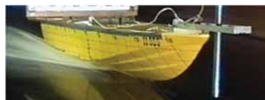
Рис. 5. Модель однокорпусного судна при испытаниях на тихой воде
