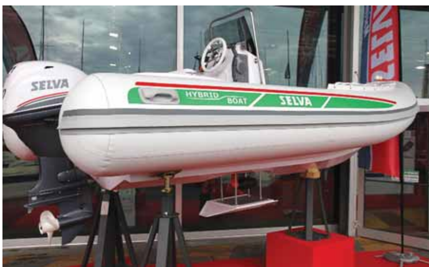
Гибридная силовая установка пакетного РИБа Selva состоит из двух подвесников: бензинового и электрического
