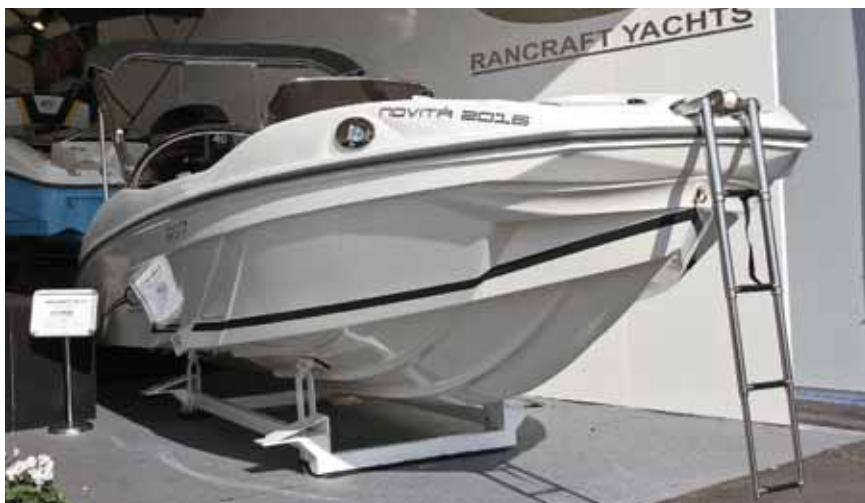
Патентованная форма носовой части катеров Rancraft призвана улучшить прохождение высокой волны
