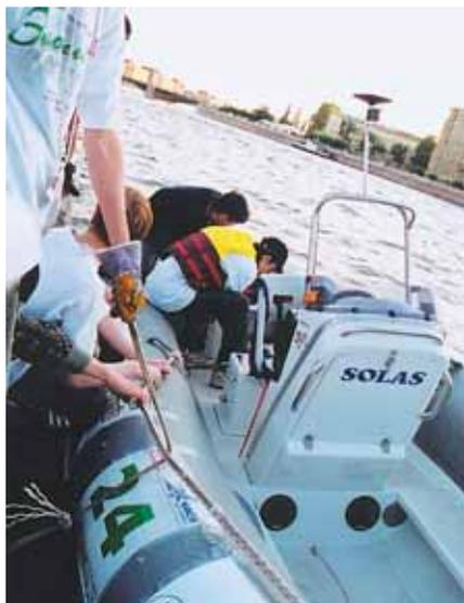
даже этот «недоросток» успешно отклонял поток воздуха вверх, отчего вести лодку можно было с откинутым забралом шлема, а кроме того, он послужил дополнительной точкой опоры для дуги с мачтой, на которую мы установили топовый и ходовые огни. А на боковины «kozyрька» поставили желтые мигающие фонари аварийной сигнализации — и красиво, и практично.
