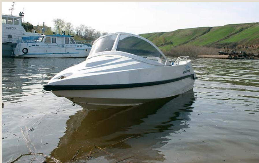
Прототип рыболовной версии — “Альбатрос” с классической “автомобильной” компоновкой
