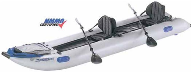
Длина лодки — 4.20 м (кокпита — 3.8), ширина лодки — 0.99 м (кокпита — 0.4), РАЗМЕР УПАКОВКИ — 0.96 × 0.48 × 0.25 м, ДИАМЕТР БАЛЛОНА — 0.35 м, ВРЕМЯ СБОРКИ — 7 мин., ВЕС — 25.7 кг
