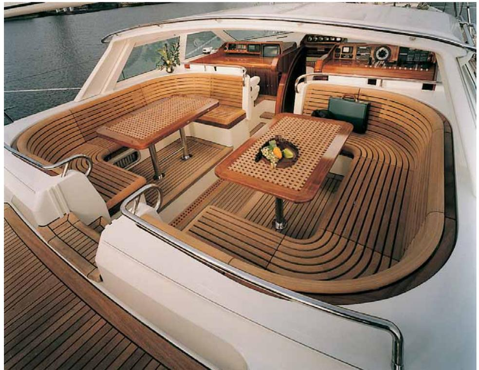
Неправильное и некачественное нанесение грунтовки может оказать пагубное влияние на долговечность покрытия из-за преждевременной разгерметизации швов между планками. Грунтовать швы можно после тщательной очистки и обезжиривания зазоров планок. Грунтовка наносится тонким ровным слоем за один проход. После ее высыхания поверхность должна блестеть и создавать впечатление "мокрой". Зазоры можно заполнять герметиком через один час.
