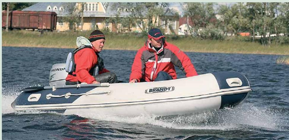
некоторой предельной скорости перемещением центра тяжести почти не удается. Тем не менее данная особенность способствует уменьшению размахов качки на попутной волне, а довольно широкий нос с привальным профилем хорошо отражает брызги при входе в нее; при этом носовые секции фанерного пайола хотя и опасно “поигрывали”, но не ломались (замечено во время теста на двухбалльном волнении). С двумя испытателями максимальная достигнутая скорость составила 36.5 км/ч, что в общем совсем неплохо.
