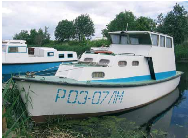
Рис.14. В данном достаточно типичном случае в жертву обитаемости помещений принесены и мореходные качества судна, и палубная эргономика, и внешний вид
