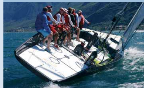
Основные данные яхты “Russell Coutts 44”: длина — 13.35 м, ширина — 2.75 м, осадка — 2.90 м, водоизмещение — 3560 кг, масса балласта — 2010 кг, площадь парусности, м²: генюя — 60, грот — 70, геннакер — 170, экипаж — 5-7 чел.
