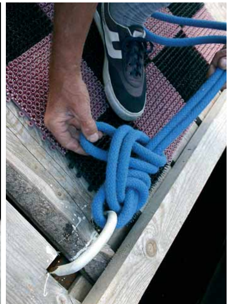
Рис. 11. Длинный трос задействуют при закладке за рым частично, согнув вдвое
