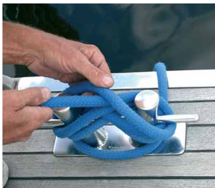
Рис. 3. Классическая стопорная петля закладывается так
