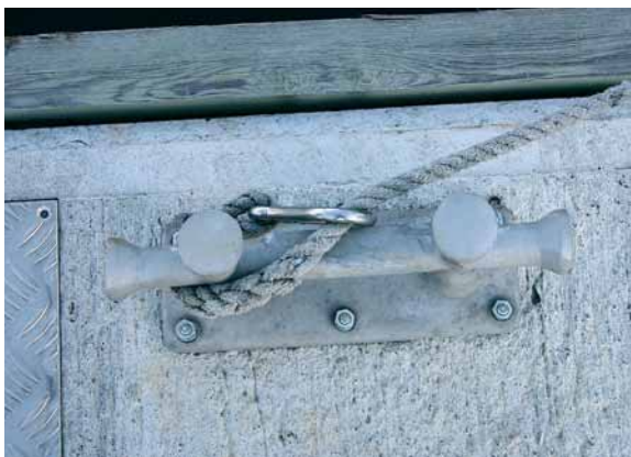
Рис. 7. КОНЕЦ С КАРАБИНОМ ЗАВОДИТСЯ ЗА ДВУХОПОРНЫЕ УТКИ ИЛИ КНЕХТЫ, КАК ЗА ОБЫЧНЫЙ РЫМ — ЕСЛИ ПРОСТО НАКИНУТЬ НА НИХ ПОЛУЧИВШУЮСЯ ПЕТЛЮ, КАК НА ФОТО, ОНА МОЖЕТ СОСКОЛЬЗНУТЬ
