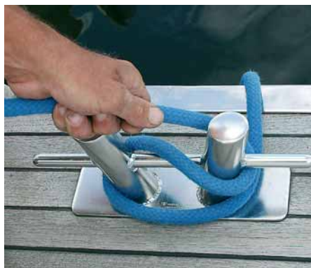
Рис. 2. И на утки, и на кнехты швартовный конец закладывается "восьмеркой"
