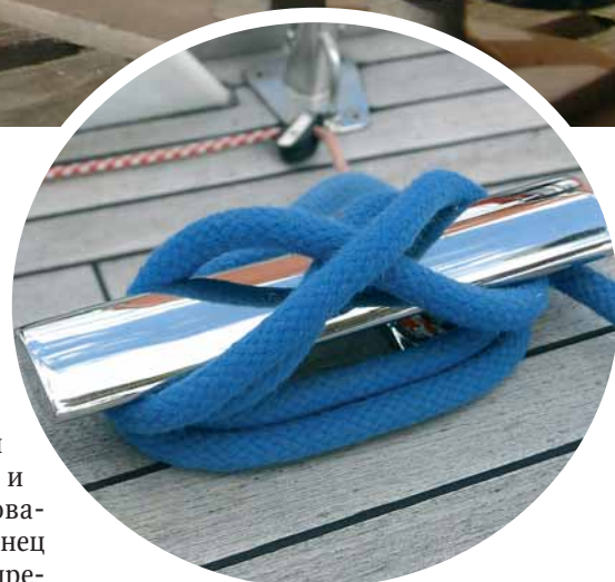
Рис. 4. На утке застопорить конец можно простой намоткой
