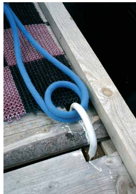
Рис. 8. ЗАКЛАДЫВАТЬ КОНЕЦ ЗА РЫМ ЛУЧШЕ НЕСКОЛЬКИМИ ШЛАГАМИ, ЧТОБЫ ОН НЕ ПЕРЕТЕРСЯ
