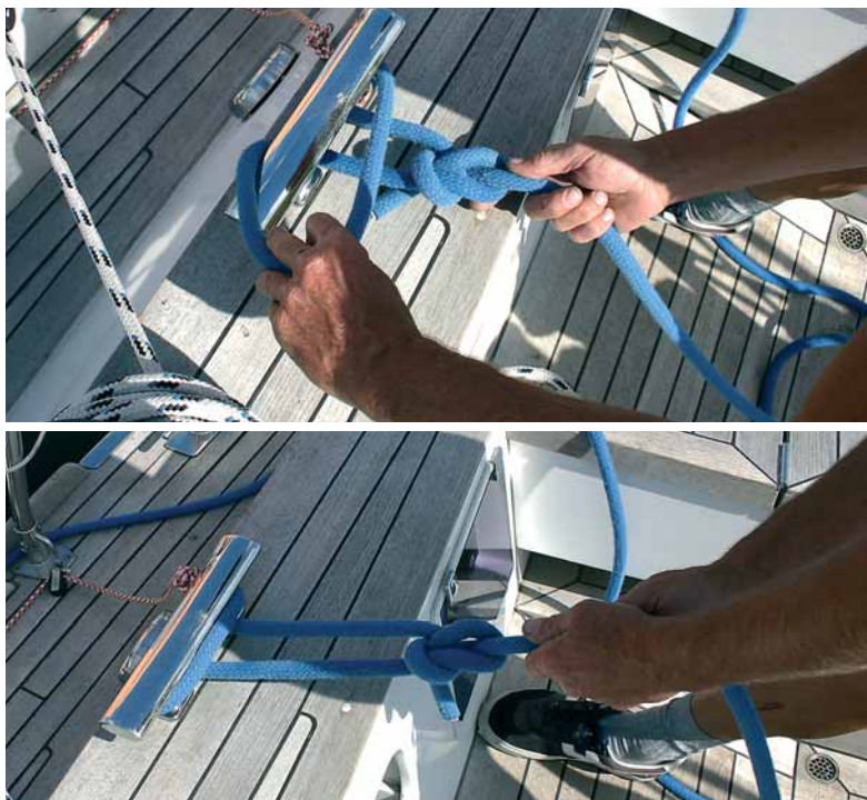
Рис. 5. ТАКИМ ОБРАЗОМ ЗАКЛАДЫВАЕТСЯ ОГОН НА УТКУ ИЛИ КНЕХТ С ДВУМЯ ОПОРАМИ
