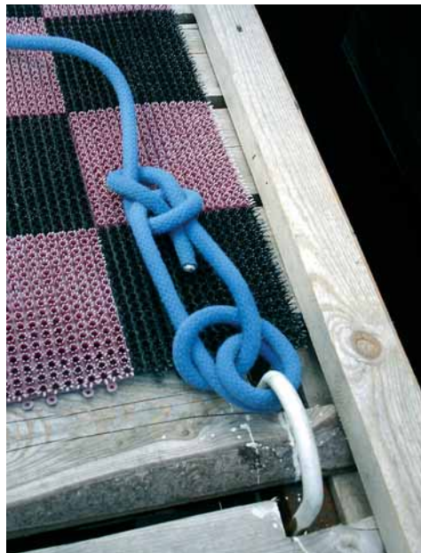
Рис. 10. На рыме наиболее надежен беседочный узел; свободный конец троса можно предварительно пропустить сквозь шлаг на рыме
