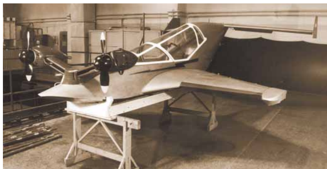
Одноместный спортивно-прогулочный экраноплан, спроектированный Е.А.Крамаревым по аналогичной со скутером аэродинамической схеме и способный летать в самолетном режиме
