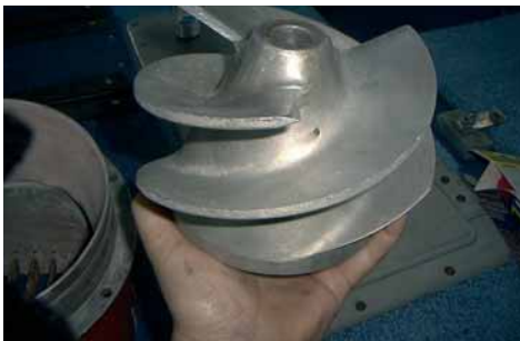
Рис. 6. Рабочее колесо центробежного ВД имеет коническую форму
