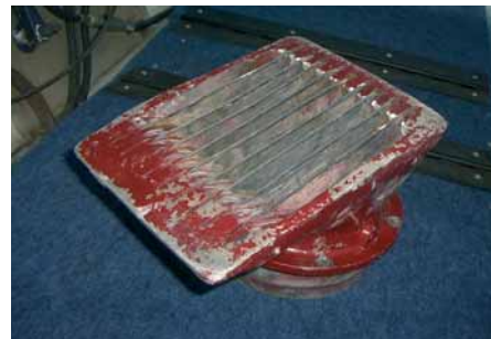
Рис. 7. Решетка водозаборника — наиболее изнашиваемая часть ЦВД
