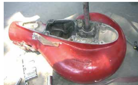
Рис.4. Основная деталь центробежного ВД — "улитка"
