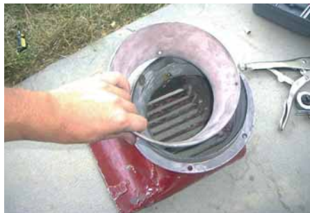
Рис. 5. Совмещенная с водозаборником обечайка ротора нуждается в периодическом осмотре
