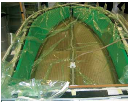
Рис. 4. ДВИЖЕНИЕ СМОЛЫ ПО КАНАЛАМ В ПЕНОПЛАСТЕ
