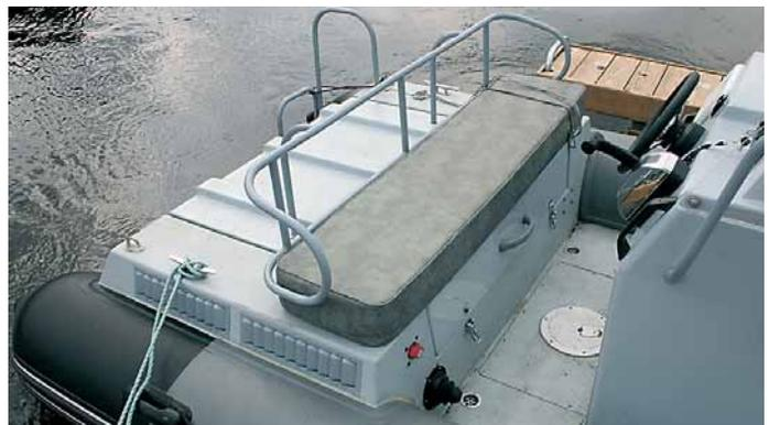
бокам от водителя на широком кормовом сиденье с простенькой трубчатой спинкой могут устроиться еще двое. Капот мотора вместе с сиденьем откидывается назад, обеспечивая великолепный доступ в “машинное отделение” (скорее всего, именно так будут именовать этот отсек пользователи в флотской форме). Удобно расположена и заливная горловина топливного бака — на передней стенке консоли, так что в случае чего дозаправиться из канистры можно даже в сильную качку.
