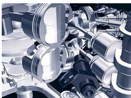
Пространственная схема деталей поршневой группы и ГРМ
