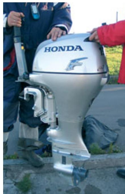
быть где-то на уровне одноклассников, если бы ее ход дополнительно не ухудшали прохваты воздуха на волне и при резких поворотах. Четырехтактные моторы слегка уступили двухтактным налегке, но уже с двумя пассажирами оказались быстрее последних — тянут они лучше и менее чувствительны к нагрузке, особенно "Honda" с ее самым высоким объемом цилиндров (350 см<sup>3</sup> против 302 см<sup>3</sup> у "Suzuki").
