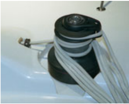
Приятные мелочи: полуутопленные лебедки, внутренняя проводка шкотов, углепластиковые накладки на вырезы в палубе (внизу)
