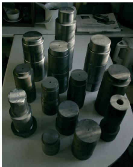
Рис. 2. Пояски на «холодильнике», имитирующие подшипники, должны быть выточены с высокой точностью
