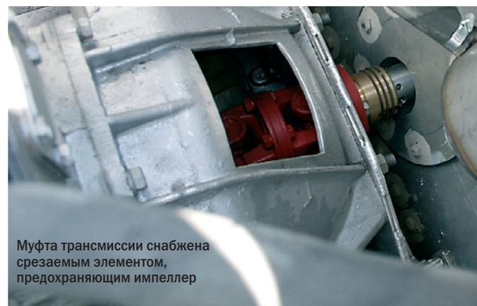
Муфта трансмиссии снабжена срезаемым элементом, предохраняющим импеллер
