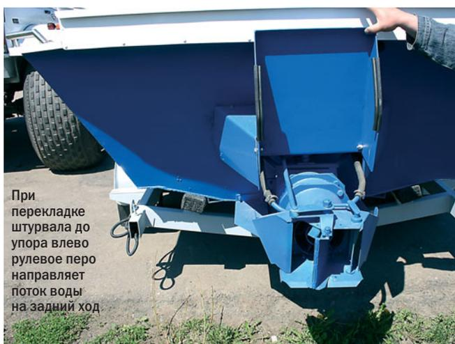
При перекладке штурвала до упора влево рулевое перо направляет поток воды на задний ход.
