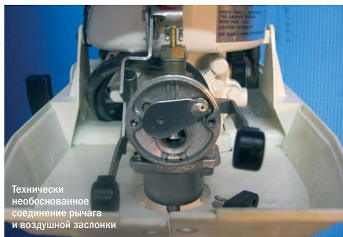
Технически необоснованное соединение рычага и воздушной заслонки
