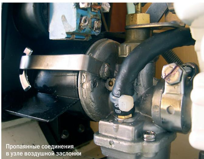
Пропаянные соединения в узле воздушной заслонки
