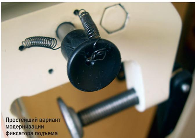
Простейший вариант модернизации фиксатора подъема
