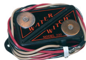
Рис. 11. Сенсорные датчики не имеют движущихся частей, хотя грязи в трюме тоже не любят
