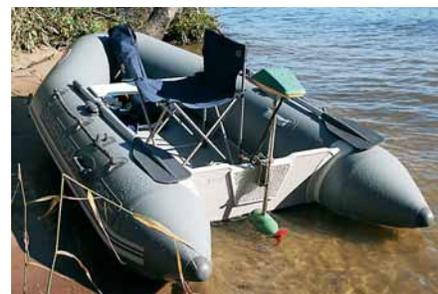
Как показал тест, устанавливая моторы «Minn Kota Enduro 30» и аналоги надо так, чтобы муфта ограничения погружения находилась в таком положении, при котором «барашек» винта не мешал бы откидке мотора. Дело в том, что «язычок», фиксирующий положение наклона мотора при неправильном размещении муфты, упирается в нее и не дает возможности наклонить мотор. Это может стать препятствием при попытке подхода «под мотором» к берегу в режиме «мелкая вода» или просто по ходу дела изменить наклон мотора.
