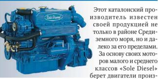
водства «Mitsubishi» и «Nissan», за исключением модели «SM-90». Модели «Mini-33», «-44», «-62» и «-74» созданы на базе силовых агрегатов «Mitsubishi», а модель «SN-85» – на базе «Nissan». Модель «SM-90» снимается с производства, но пока в продаже еще есть.
